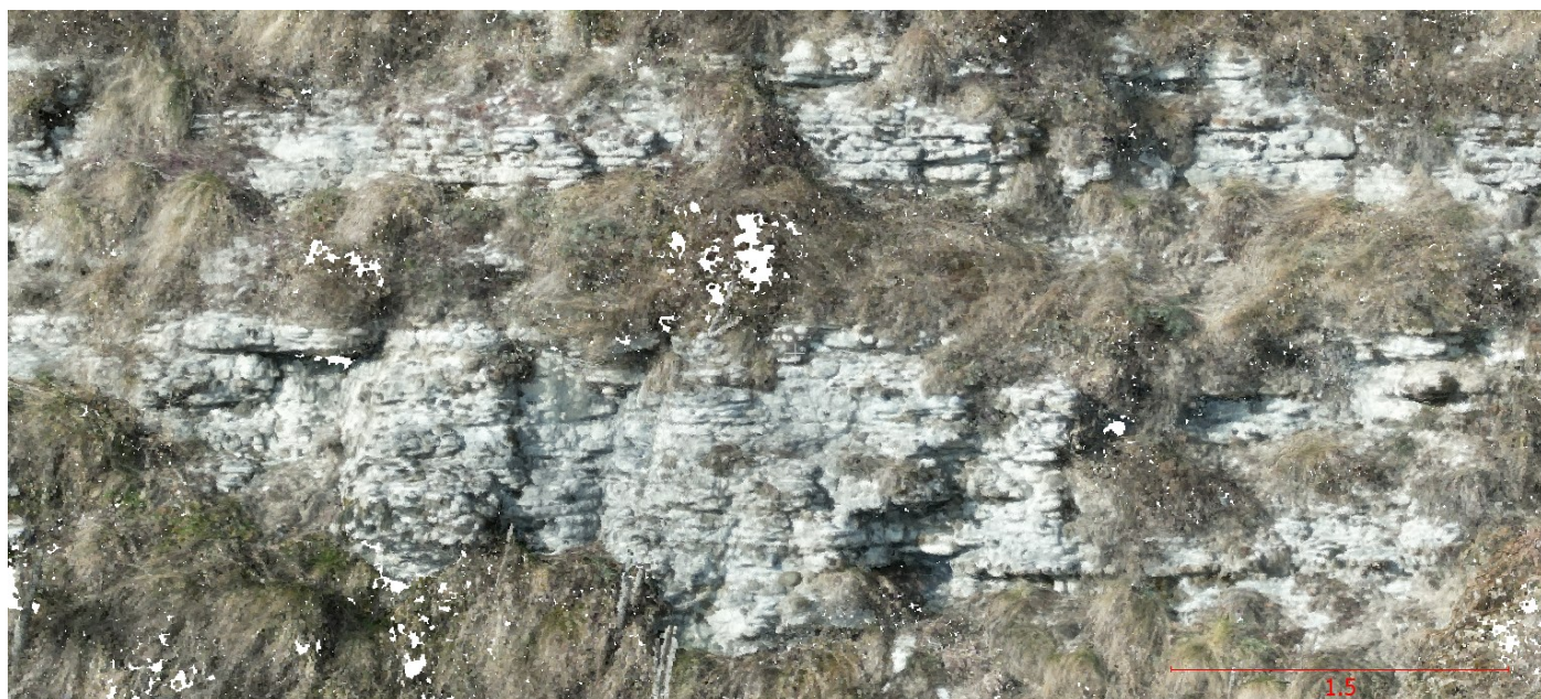
Figura 15 Fasce rocciose nella parte sommitale del versante (immagine da nuvola di punti) – Stratificazione dell'ammasso
