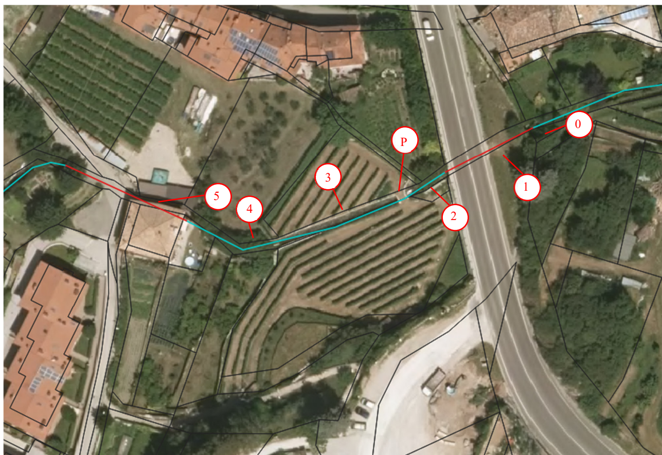
Figura 5.16 Estratto planimetrico della roggia di Padergnone in centro al paese e sezioni critiche rilevate
