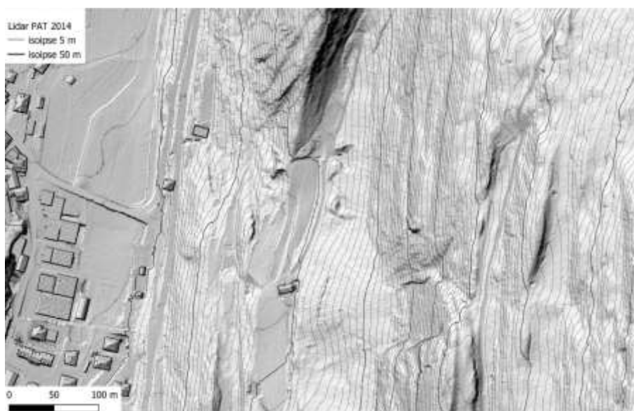
Figura 4.3 Ombreggiamento con isopse a 5-50 m
