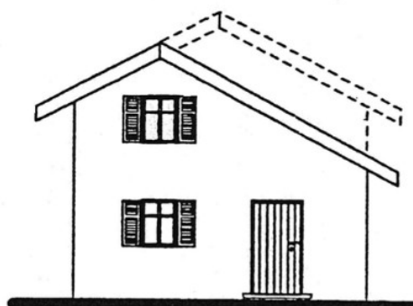
EDIFICIO CON COLMO ASIMMETRICO
