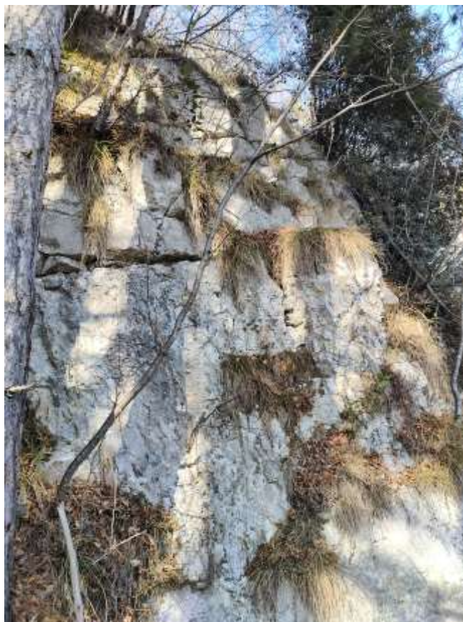
Figura 6.13 Esempio di variazione delle caratteristiche dell'ammasso roccioso (strato fratturato alternato a strato compatto).
