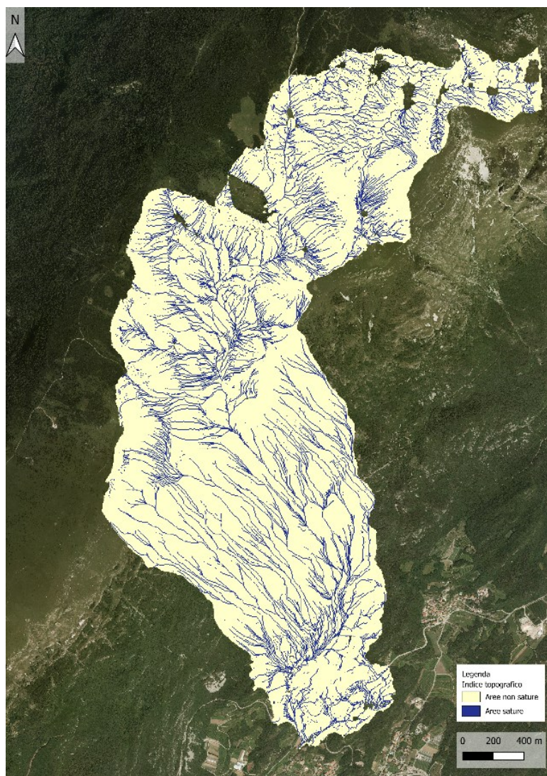
Figura 5.5 Indice Topografico del bacino della roggia di Fraveggio
